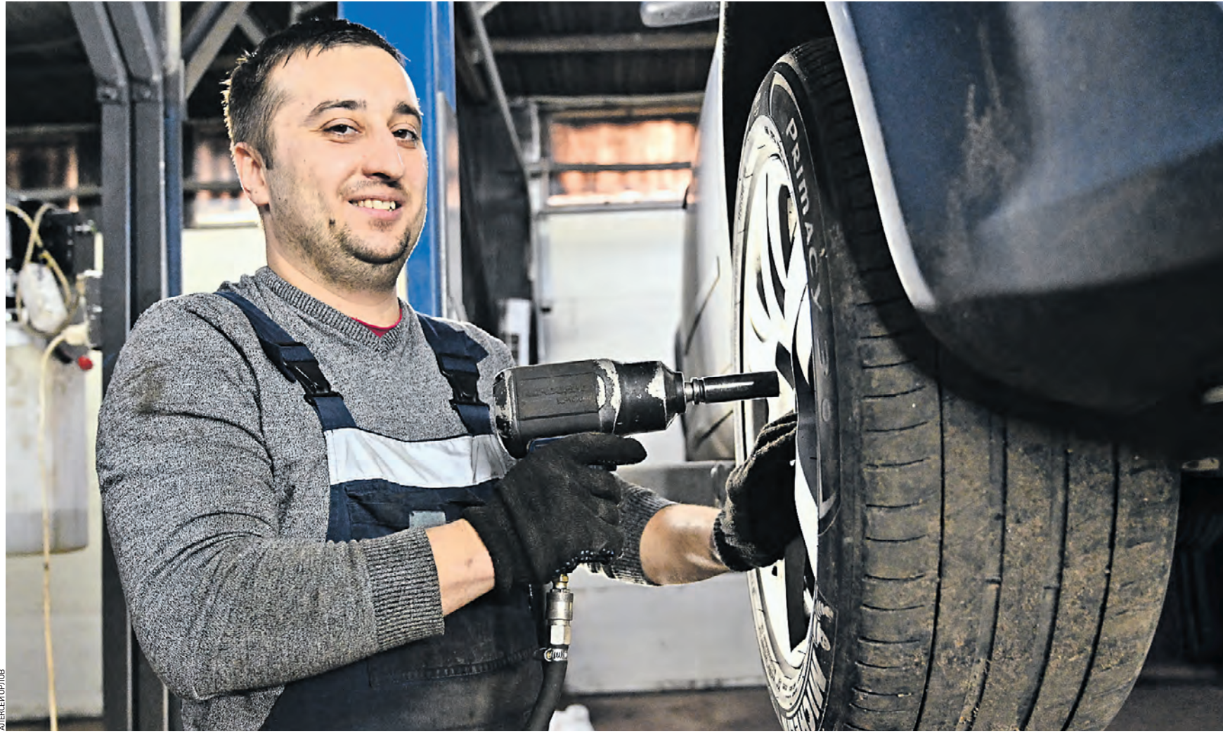
25 октября 2021 года. Автослесарь Андрей Талаков меняет резину в автосервисе. Эксперты рекомендуют: накануне лета «переобуться» нужно обязательно. Ни зимняя резина, ни всесезонка неэффективны на горячем асфальте. Менять резину рекомендуется дважды в году — если вам важна безопасность
