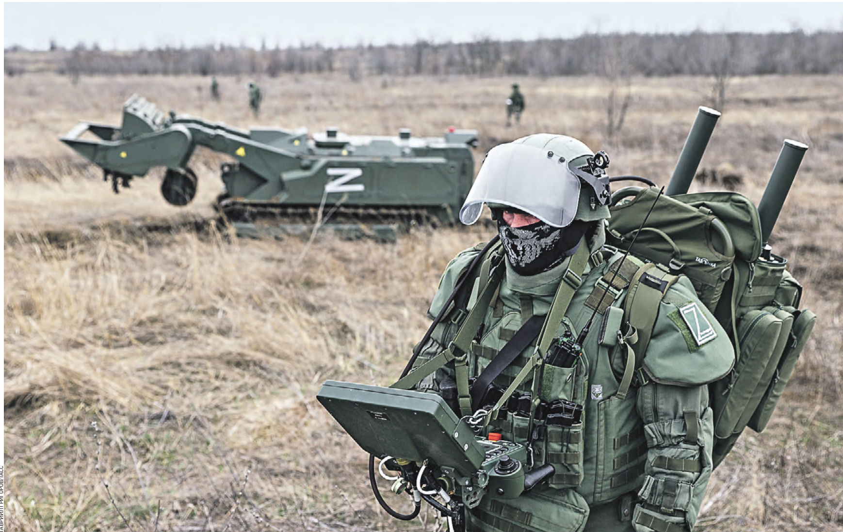
1 апреля 09:20 Луганск. Военнослужащий Народной милиции ЛНР ведет разминирование местности с помощью робототехнического комплекса «Уран-6»
