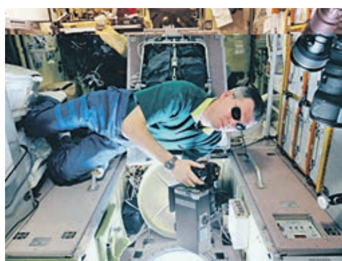
Александр Самокутьев проводит на борту МКС эксперимент «Русалка»: ручной спектральный анализатор компонентов атмосферы
