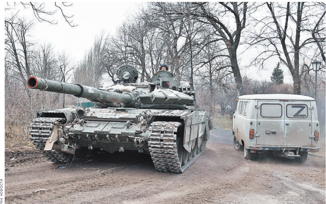
Танки Т-72БМЗ способны выдержать удар в лоб даже бронебойного подкалиберного снаряда.
