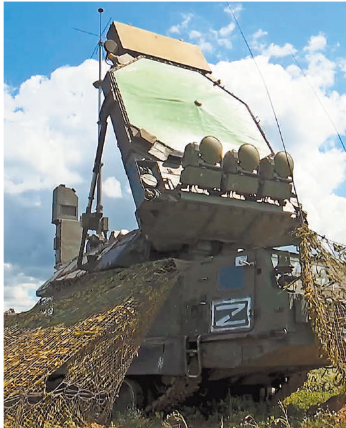
Зенитная ракетная система С-300В, которую наши военные активно используют в спецоперации на Украине, может сопровождать одновременно до 12 воздушных целей и выдавать их точные координаты сразу нескольким пусковым установкам. Многоканальную станцию наведения ракет можно назвать «глазами» этой системы ПВО. Пусковые установки — ее «руки». А мобильный передвижной командный пункт — своего рода нервная система, которая координирует действия машин и расчетов.
