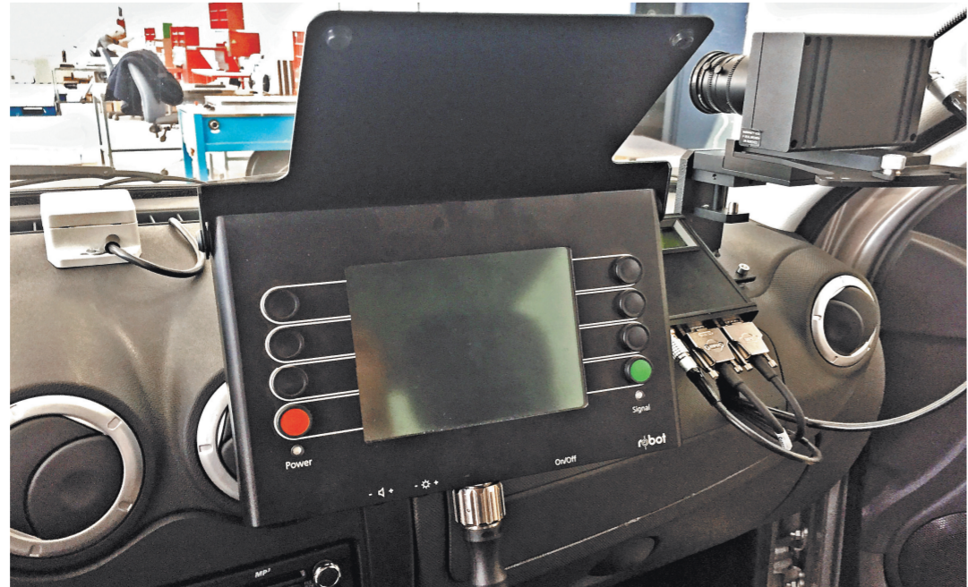
Радарный комплекс монтируется в автомобиль и может фиксировать нарушения на ходу в потоке.
