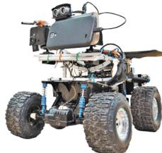
У робота есть лазерный датчик, тепловизор, видекамера, манипуляторы и куча других «наворотов».
