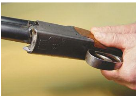
Состояние системы запирания нужно проверить на «шат» в горизонтальной и вертикальной плоскости
