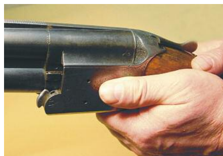
Состояние системы запирания нужно проверить на «шат» в горизонтальной и вертикальной плоскости
