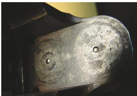
На зеркале колодки по мере увеличения настрела становится всё более заметным прогар. Видно также, что при закрывании ружья ствольный блок упирается в колодку неравномерно, а лишь частью верхнего ствола
