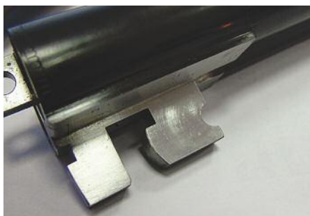
В этом ружье с колодкой взаимодействует только передний подствольный крюк
