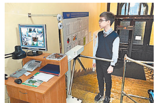
В систему входят два турникета с камерами, оснащёнными функцией распознавания лиц, облачный сервер, где хранятся изображения лиц, и компьютер сотрудника охраны.
