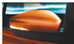
Боковые зеркала с электроприводом складывания и повторителями сигнала поворота
