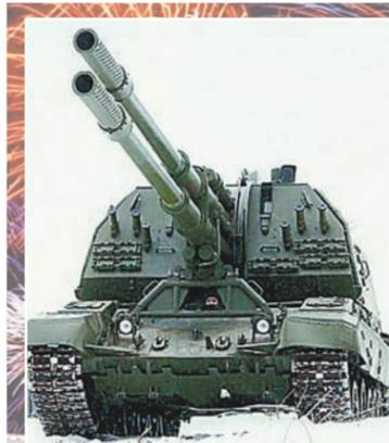
★ Самоходная гаубица «Коалиция» имеет полностью автоматизированную систему заряжания. Один её выстрел из двух стволов сразу - уже залп!
