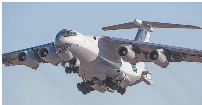
Отличить танкер от грузовика можно по агрегатам заправки справа под крылом и около хвоста.
